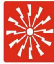
ALLARME ANTINCENDIO PULSANTE DI SEGNALAZIONE INCENDIO
